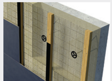
Méthode de fixation thermiquement optimisée avec vis d'écartement
