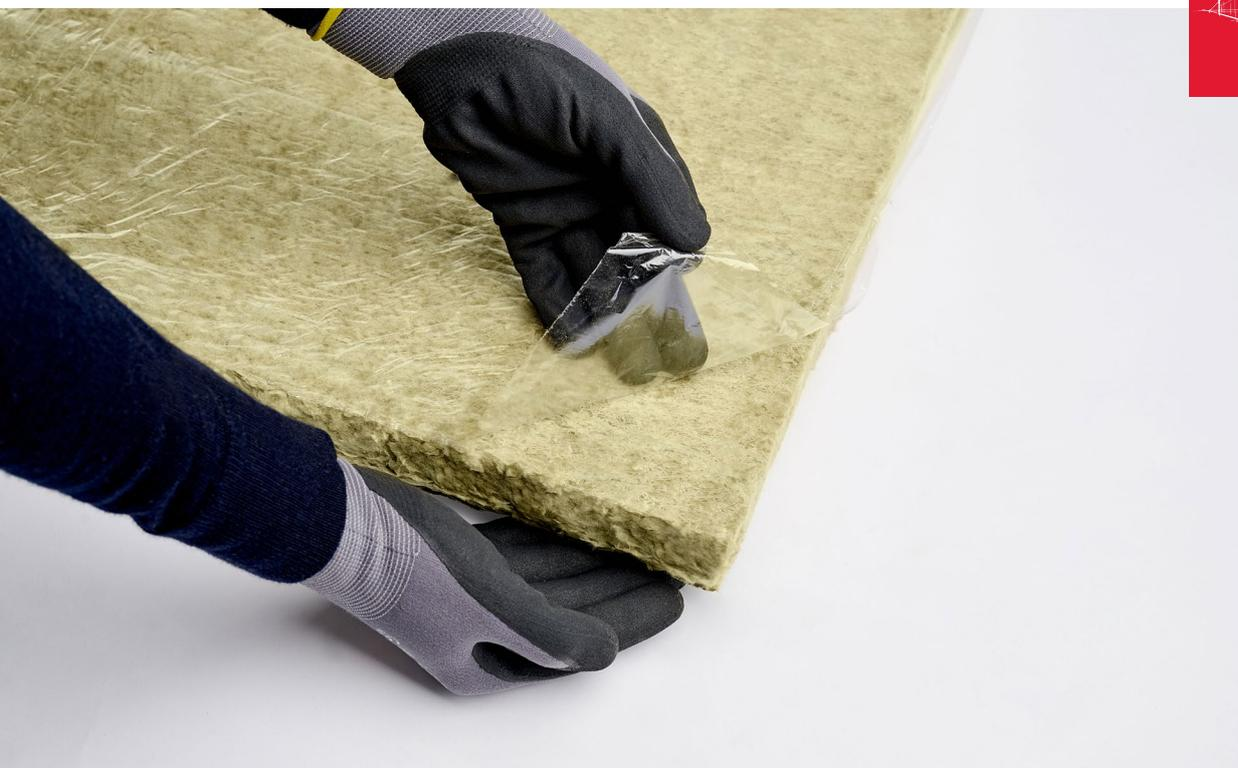
Die ROCKWOOL LM Klima EF ist einseitig mit einer Aluminiumfolie kaschiert und auf der Wollseite mit einer selbstklebenden Beschichtung ausgerüstet. Sie kann direkt mit dem zu dämmenden Bauteil verklebt werden. Die Klebeschicht ist mit einer abziehbaren PE-Folie abgedeckt. Rastermarkierung auf der Aluminiumfolie für einfachere und schnellere Verarbeitung.
