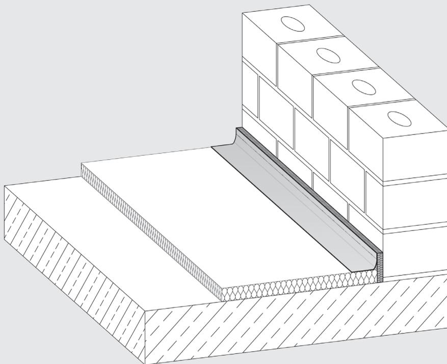
Steinwolle\* Randdämmstreifen mit aufkaschierter Folienlasche für die Entkopplung von Estrichaufbauten auf Geschoss- und Rohdecken
