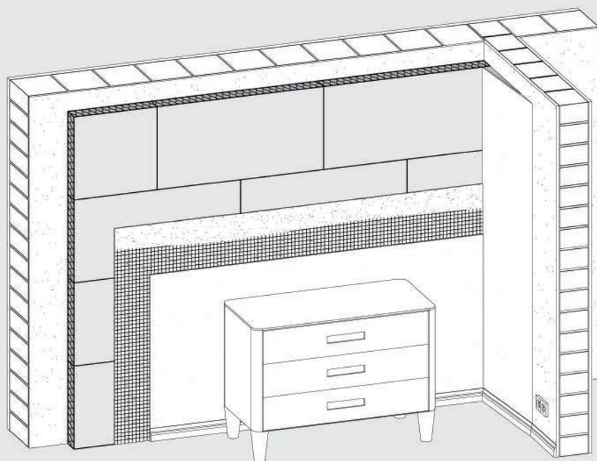
Nichtbrennbare Steinwolle-Dämmplatte\* als Dämmstoffkern von Innendämm-Systemen zur Dämmung von Außenwänden.
