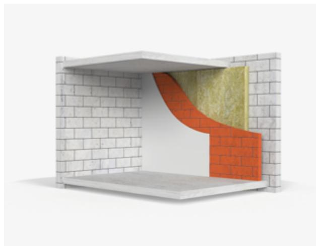
**2** Exemple de contre-cloison maçonnée en brique creuse avec enduit plâtre.
