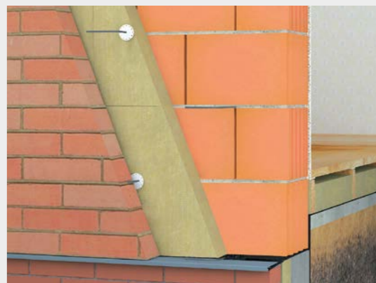
Akmens vatos plokštės VENTIROCK / VENTIROCK F trisluoksnėse vėdinamose sienose montuojamos tvirtinant plieniniais arba stikloplėšio ryšiais (smeigėmis).
