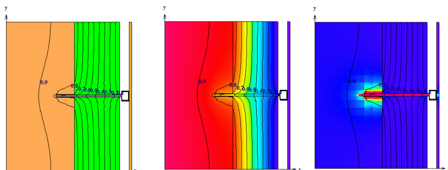
6 pav. Detalės pjūvis trimačio temperatūrinio lauko skaičiavimo HEAT3 programoje (medžiagos, temperatūros, šilumos srautai), vaizdas iš viršaus
